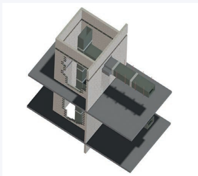
Rys. 1. Szacht instalacyjny (serwisowy). Ściana szachtu nie jest częścią kanału oddymiającego Vew
