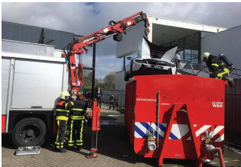
Fot. 1. Gaszenie samochodu elektrycznego w kontenerze z wodą, materiały prasowe straży pożarnej w Brabancji Środkowej i Zachodniej, Holandia
