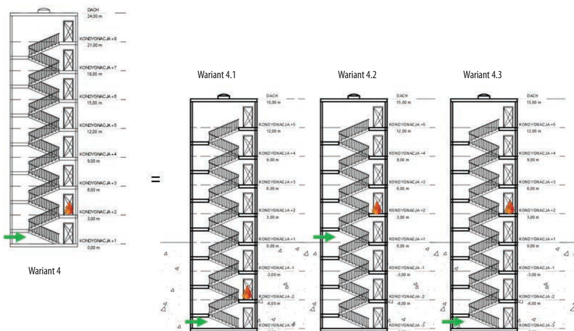
Rys. 3. Analiza oddymiania osmiokondygnacyjnego budynku z kondygnacjami podziemnymi
