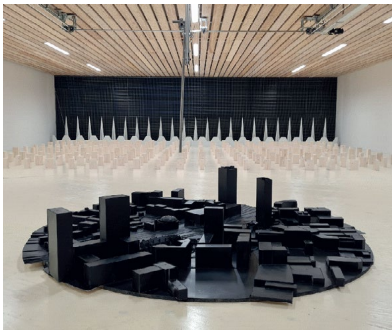
Model zabudowy wielkomejskiej na stole obrotowym tunelu aerodynamicznego TA1 D
